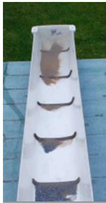
Εικ. 3. Κατασκευή ρείθρου με αναχώματα για το διαχωρισμό του χρυσού
