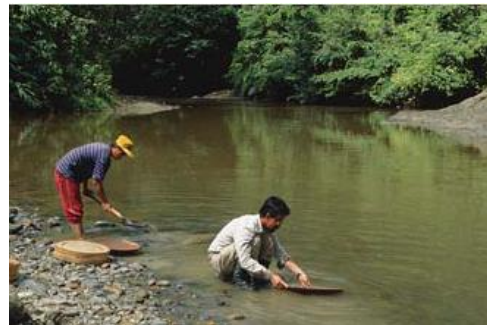
Εικ. 7. Η μέθοδος συλλογής με πιάτο (panning)
