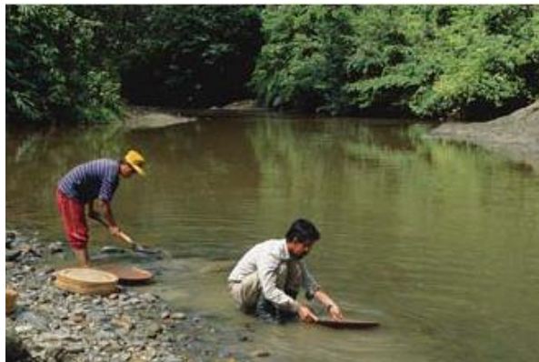
Εικ. 7. Η μέθοδος συλλογής με πιάτο (panning).
