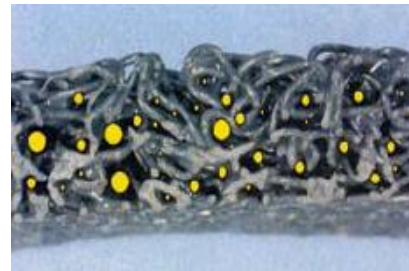
Εικ. 4. Τα ψήγματα του χρυσού παγιδεύονται στο τρίχωμα
