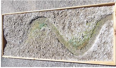
Εικ. 6. Ρείθρο για την αναπαράσταση της συγκέντρωσης ψηγμάτων χρυσού στους μαιάνδρους.
