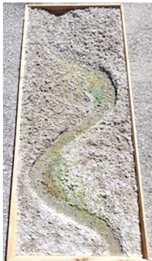
Εικ. 6. Ρείθρο για την αναπαράσταση της συγκέντρωσης ψηγμάτων χρυσού στους μαϊάνδρους
